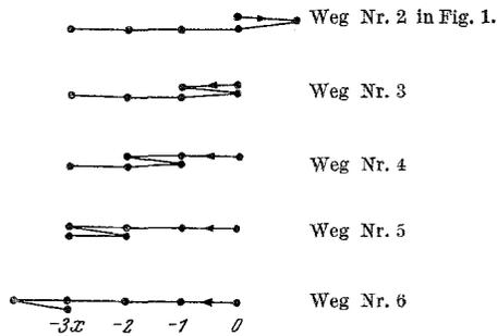
Abb. 1. Mögliche Bewegungen eines Teilchens bei Vorgabe einer Verschiebung in der + Richtung und vier Verschiebungen in der - Richtung.
