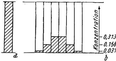
Abb. 2. Die diffundierende Substanz hat sich vom Anfangszustand  $t = 0$  (Abb. 2 a) bis  $t = 5$  in den 6  $x$ -Abschnitten so verteilt, daß die Konzentrationen (Abb. 2 b) sind
